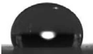
Gota de agua sobre una superficie pintada con SurfaPaint Aqua X Ángulo de contacto: 126°
