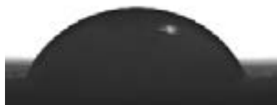
Gota de agua sobre una superficie pintada con una pintura normal. Ángulo de contacto: 60°
